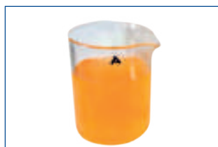
Acqua impianto non trattata
